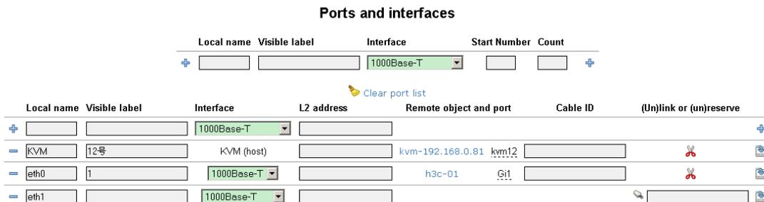
和端口“Ports”相关（网络接口）的会有 IP 地址，在录入端口映射地址前必须完善 IP 地址，如下图所示。
